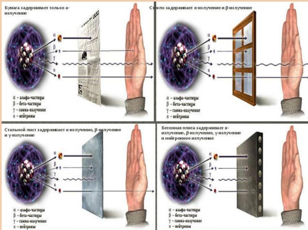
Различают корпускулярное и фотонное ионизирующие излучения. Корпускулярное ионизирующее излучение представляет собой поток элементарных частиц с массой покоя, отличной от нуля (α- и β-частиц, нейтронов, протонов, электронов и др.). Корпускулярное излучение, состоящее из потока заряженных частиц (α- и β-частиц, протонов, электронов), кинетическая энергия которых достаточна для ионизации атомов при столкновении, называется непосредственно ионизирующим излучением.
