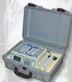
Прибор дозиметрического контроля ДВГИ-5Д
