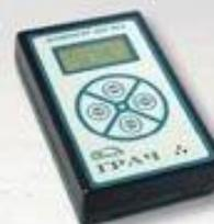
Дозиметр-радиометр ДКГ-03Д «Грач»
